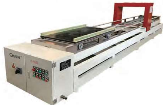
Roller type automatic demagnetizer
